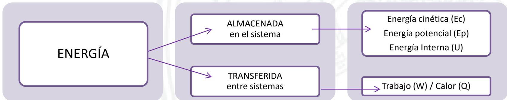
El trabajo termodinámico se define como la forma de transferencia de energía requerida para, en una evolución adiabática, alcanzar una cierta variación en la energía contenida en un sistema. Si el trabajo es de compresión/ expansión, este será igual a la integral de la variación de la presión con el volumen.
