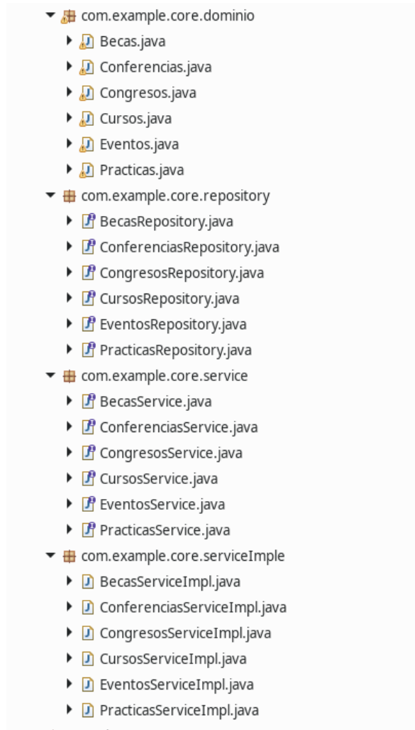
Figura 42: Paquetes Dominio, Repository, Service y ServiceImple del esquema de paquetes
