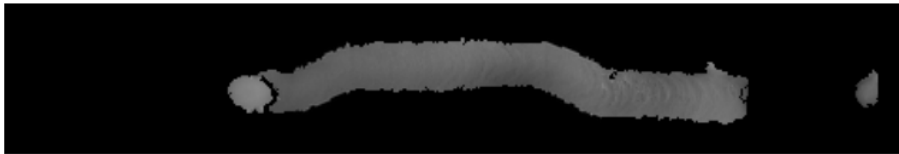
Figura 5.15: Ejemplo imagen defecto abombar arriba
