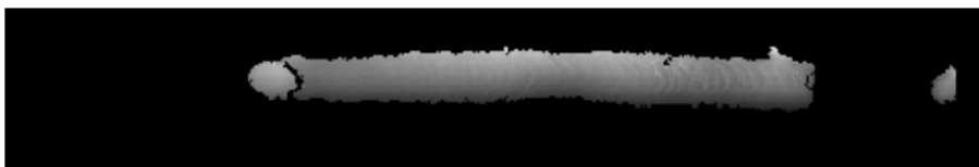
Figura 5.16: Ejemplo imagen defecto descompensación N/S
