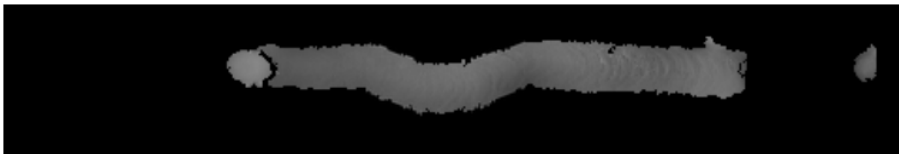
Figura 5.14: Ejemplo imagen defecto abombar abajo
