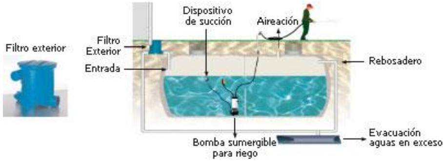
Figura 7.4.2: Esquema de funcionamiento de depósito de recogida . Fuente: ver anexo 1
