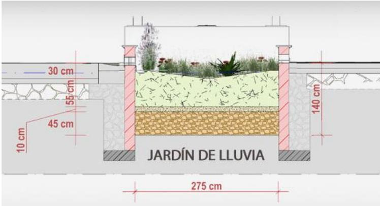
Figura 7.6.2: Detalle constructivo de un jardín de lluvia . Fuente: ver anexo 1
