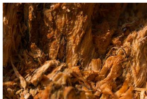
Figura 67. Ejemplo de hongo xilófago de pudriciones blandas Fuente: https://www.tecmadera.com/
