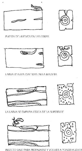
Figura 71. Ciclo de vida de los insectos xilófagos de ciclo biológico Fuente: Elaborado por el autor
