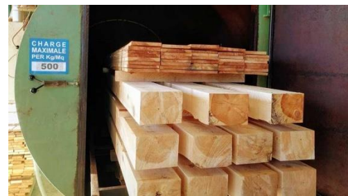
Figura 152. Imagen de tratamiento de la madera mediante autoclave de tratamiento con sales hidrosolubles Fuente: https://www.forestmaderera.com/tratamientos
