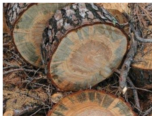
Figura 66. Ejemplo de hongo xilófago de cromógenos Fuente: http://www.reddemon.es/
