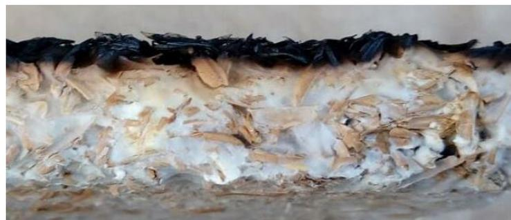
Foto detalle: formación de carbonilla en parte expuesta.
