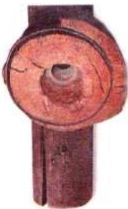
Figura 40: Tubería de madera de Manhattan, finales del s.XIX.
