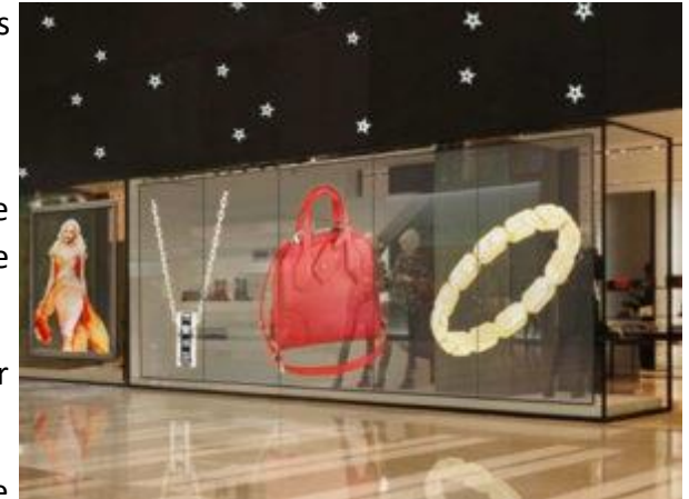
Imagen 51. Cortina de Led semitransparente. Fuente: https://dreamlux.es/noticias/tipos-de-pantallas-de-led-y-sus-clasificaciones/
