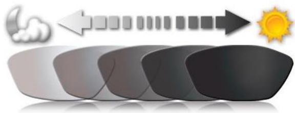
Figura 25. Funcionamiento de lentes fotocromáticas aplicable también a las termocrómicas pero dependiente de la temperatura. Fuente: https://longitudeonda.com/polimeros-electrocromicos-el-futuro-de-las-lentes-fotocromaticas/
