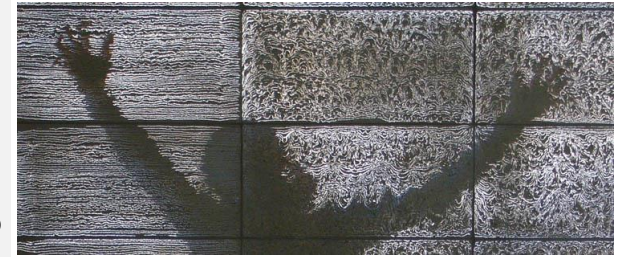
Imagen 115. Muro de bloques Litracon de Hormigón Traslúcido. Fuente: https://arquitecturayempresa.es/noticia/hormigon-translucido-litracon
