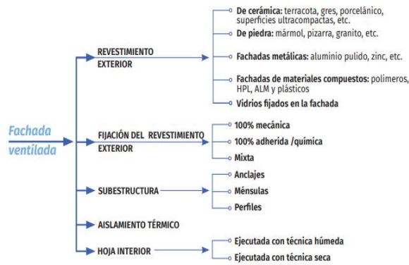
Figura 8: Clasificación de las fachadas ventiladas según sus componentes. Fuente: Manual de fachadas ventiladas de ASEFAVE
