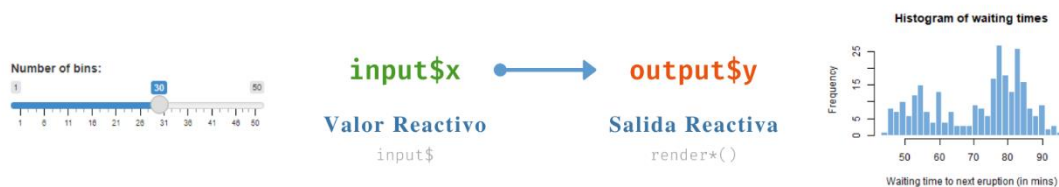
Figura 3.16. Esquema de la reactividad simple que implica un valor y una salida reactivos.
