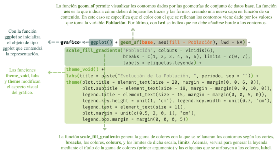
Figura 2.13. Descripción de las funciones ggplot , geom_sf y scale_fill_gradientn , del paquete ggplot2 con las que se crean las representaciones que componen los mapas animados.
