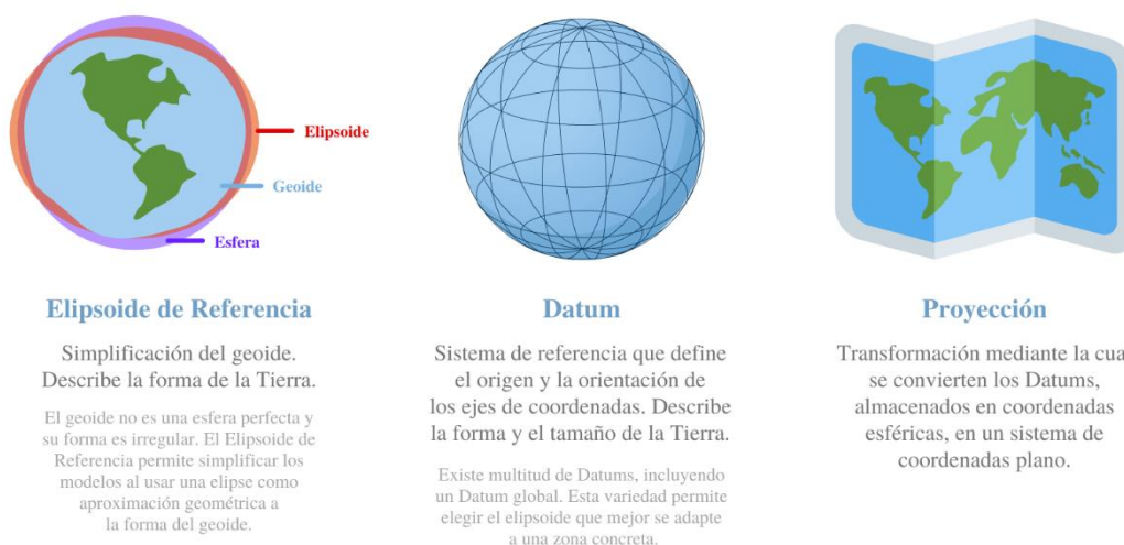
Figura 2.3. Descripción de los tres componentes principales de un CRS .
