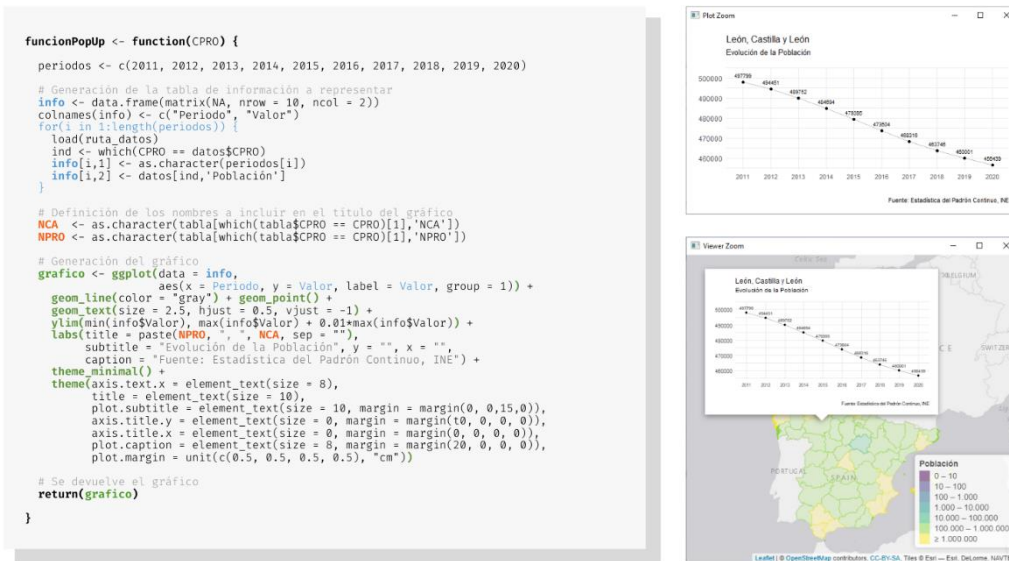
Figura 2.10. Código de la función para generar los gráficos de la evolución de las cifras de población entre 2011 y 2020 para los mapas nacionales por provincias. La imagen superior derecha muestra un ejemplo de la representación que devuelve la función y la inferior el resultado en el mapa interactivo.
