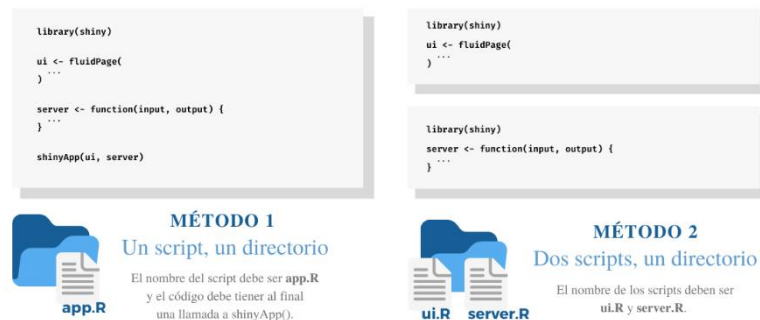
Figura 3.12. Esquema los dos métodos para guardar una aplicación Shiny.
