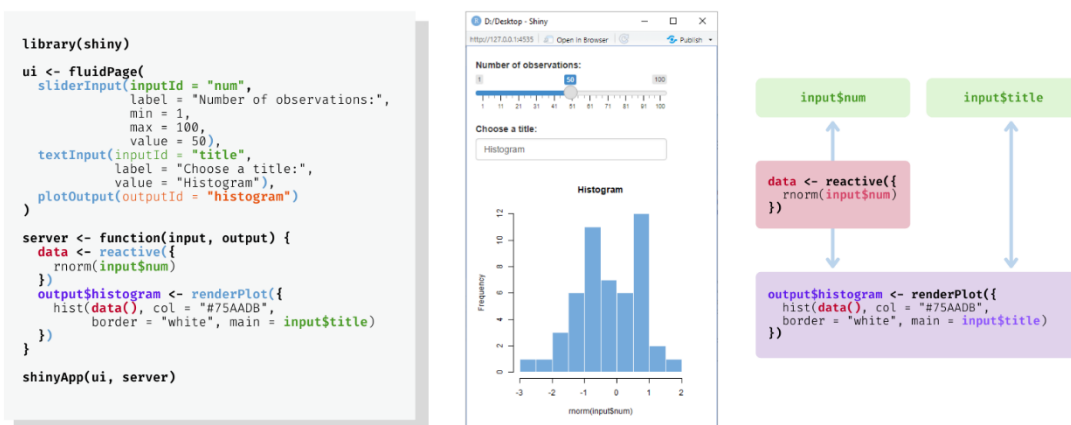
Figura 3.19. Código, apariencia y esquema de una aplicación con modularización de código.
