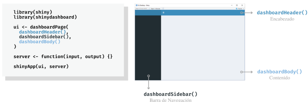
Figura 3.33. Código y apariencia del diseño predeterminado de Shiny Dashboard.
