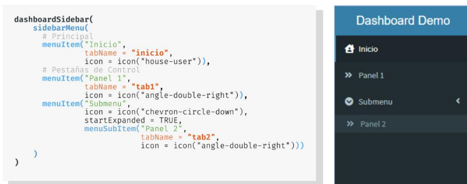
Figura 3.35. Código y apariencia de una barra de navegación con Shiny Dashboard.
