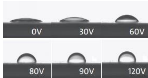
Fig.5.Variación de la forma de una gota al aplicar diferentes voltajes (Corning Technology Center)
