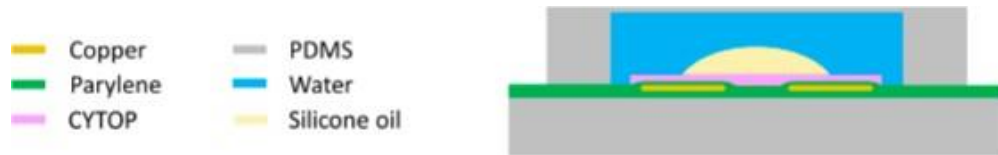
Fig. 15: Representación de la estructura de la celda que se encuentra fijada sobre una superficie flexible con una gota de aceite colocada sobre ella. (Van Grinsven et al, 2017)
