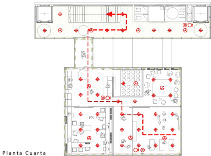
Imagen 32: Plantas evacuación de incendios Fuente: Elaboración propia
