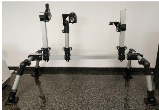
Figura 2. Base articulada con sistema de iluminación y celdilla.
