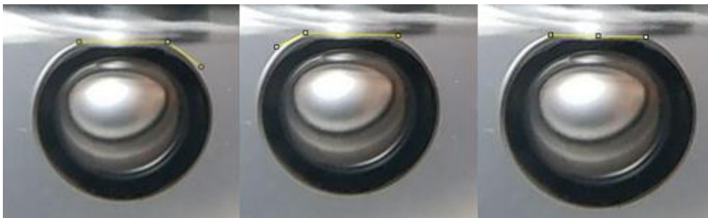
Figura 6. Medida de los ángulos entre la burbuja y la superficie de la LC y la base. Imagen obtenida mediante Image J.
