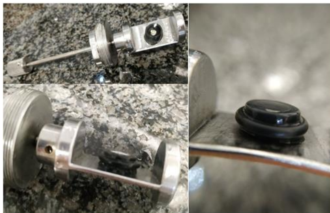
Figura 4. Arriba a la izquierda Soporte para LC. Abajo a la izquierda, parte del soporte que se introduce en la celdilla. A la derecha, LC colocada en la estructura, se sujeta a está utilizando una goma.
