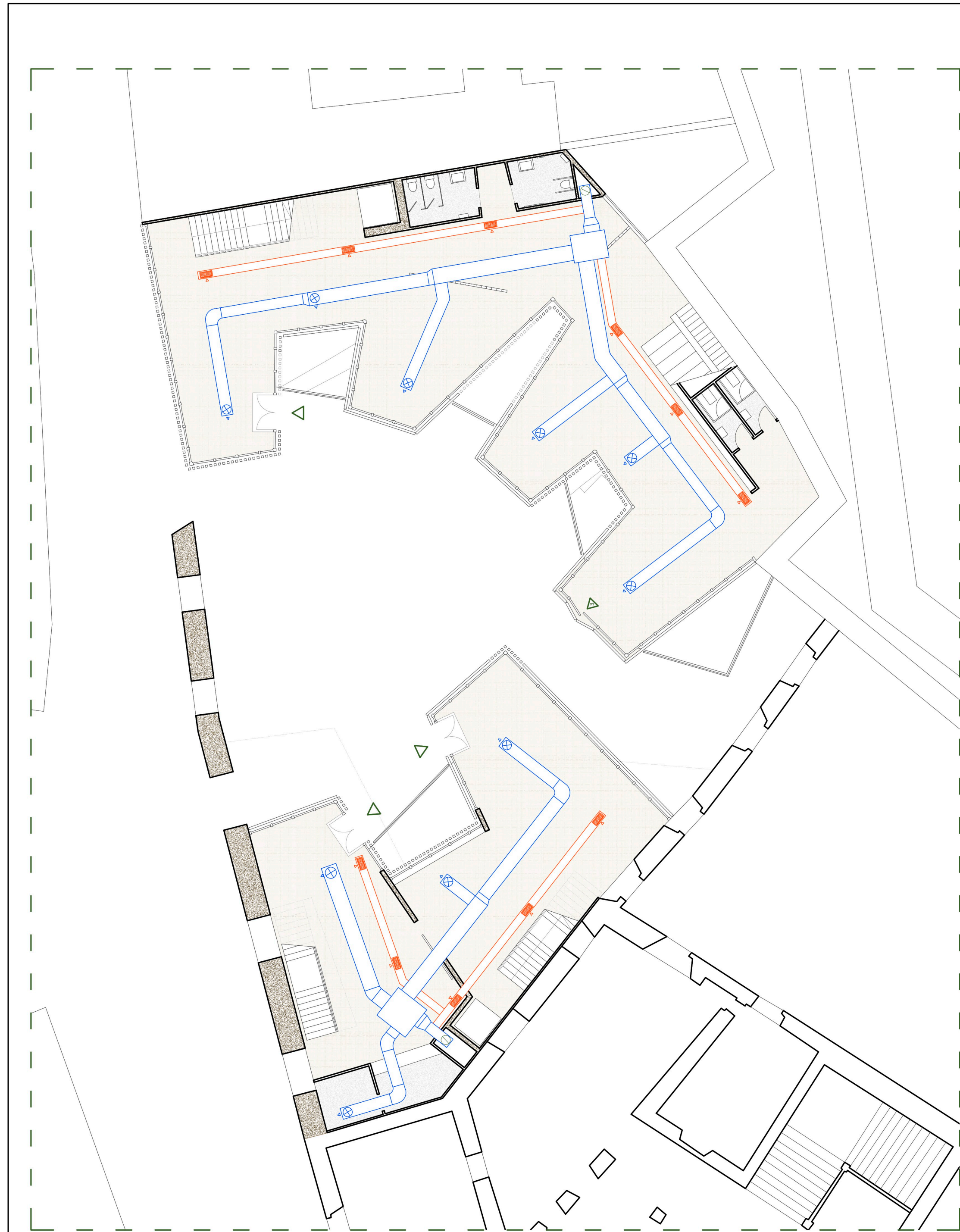
Planta de climatización PB escala 1/150
