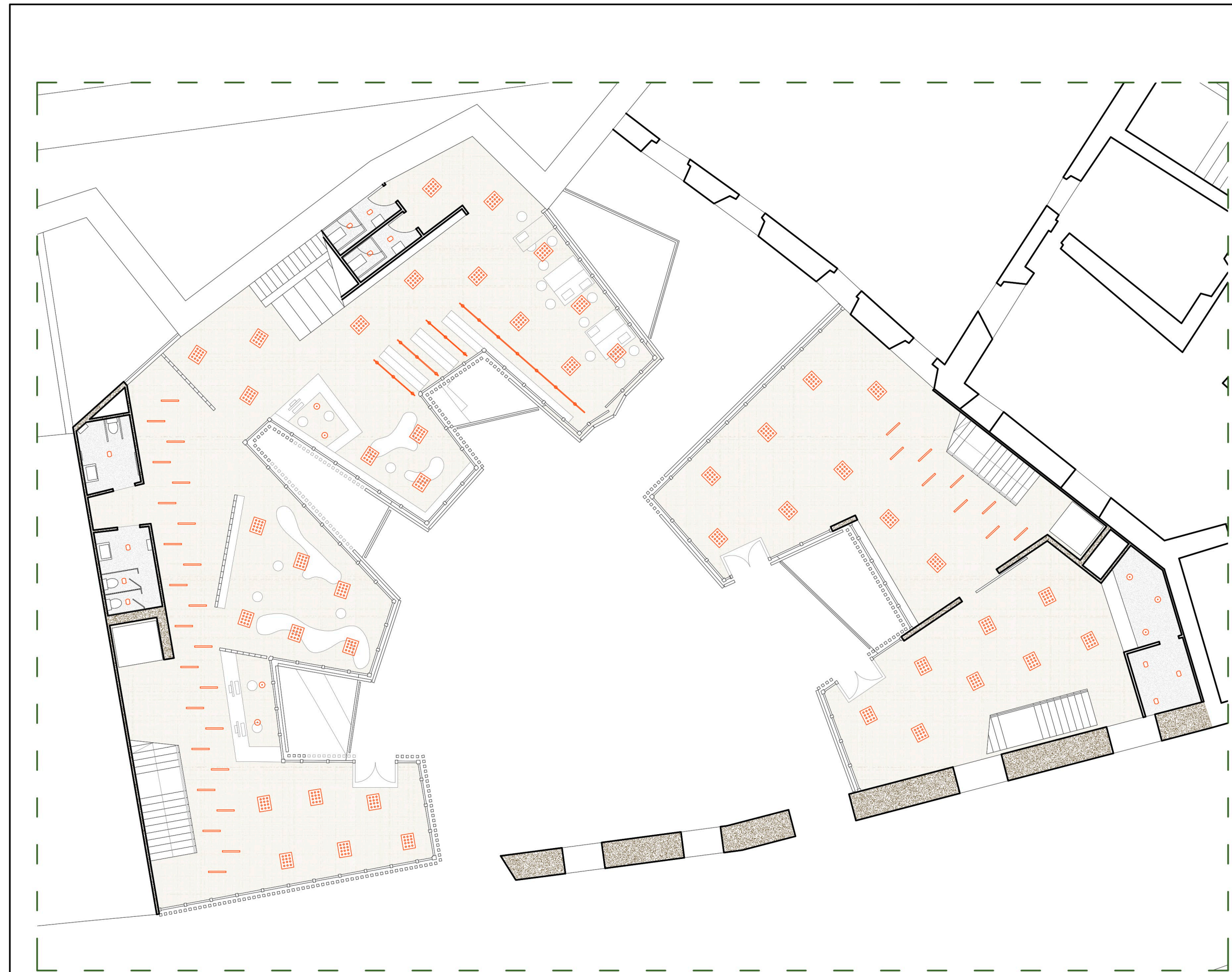
Planta de iluminación PB escala 1/150
