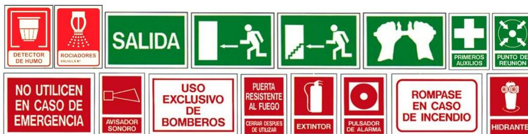
Imagen 18.- Señalización de los medios de evacuación.
