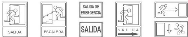
Señalización medios de evacuación
