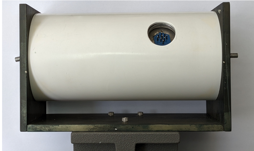
Figura 2.2: Transductor utilizado para hacer vibrar la muestra.
