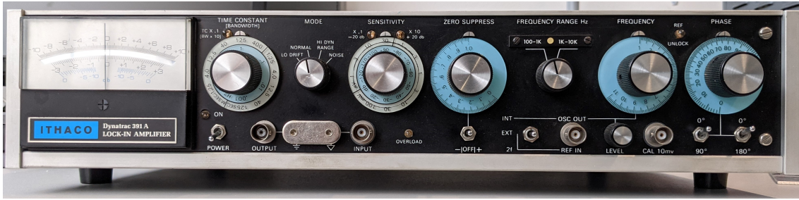
Figura 2.17: Imagen del amplificador lock-in que se iba a utilizar en un principio.
