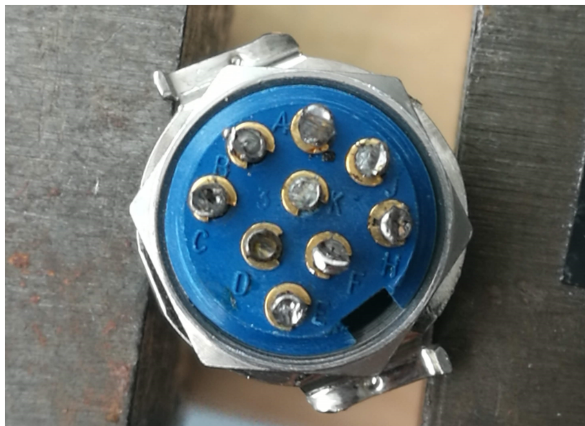
Figura 3.2: Parte anterior de la conexión del transductor.
