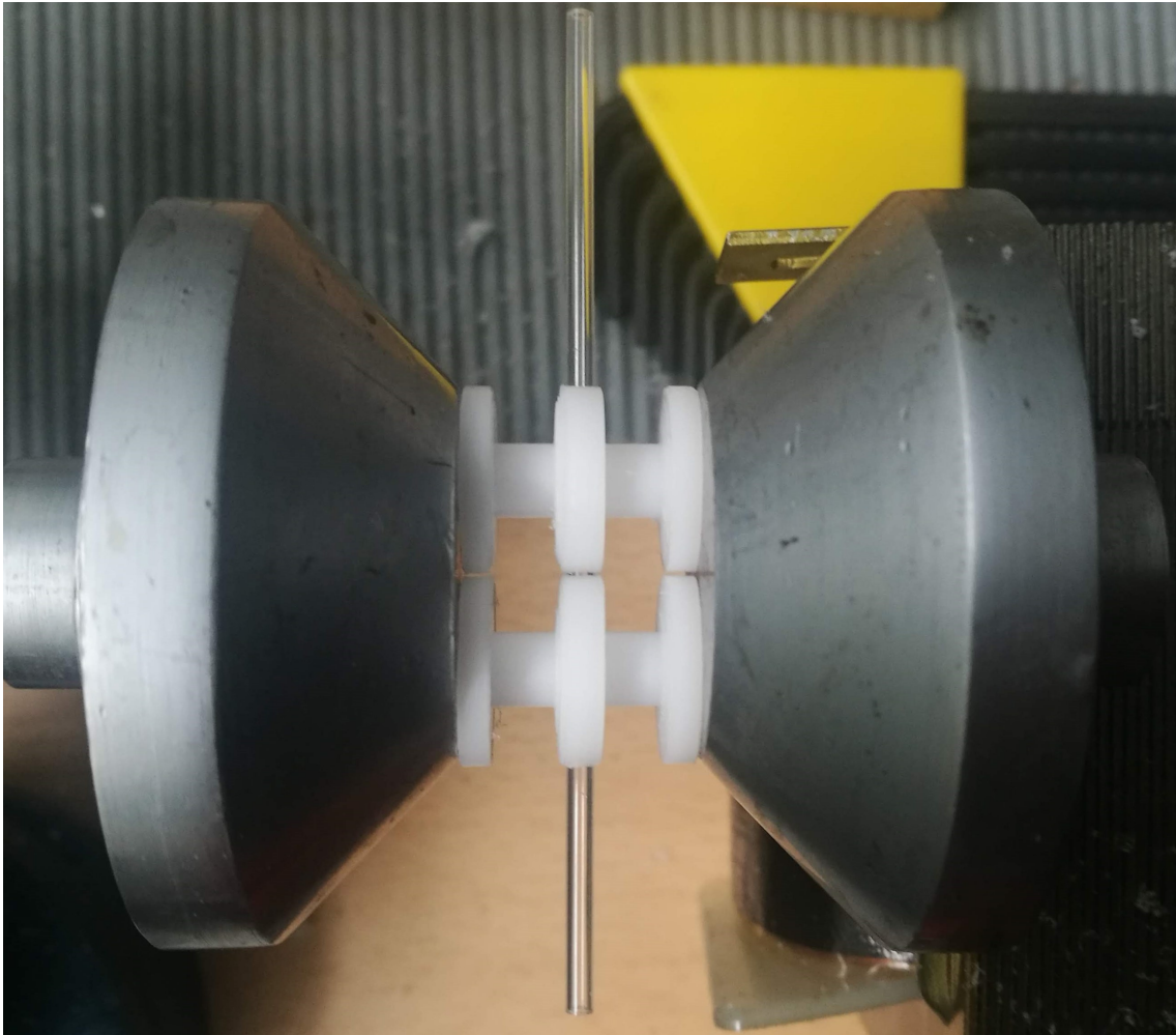
Figura 3.7: Carcasa del DCS construida entre las piezas polares con un tubo capilar atravesado.
