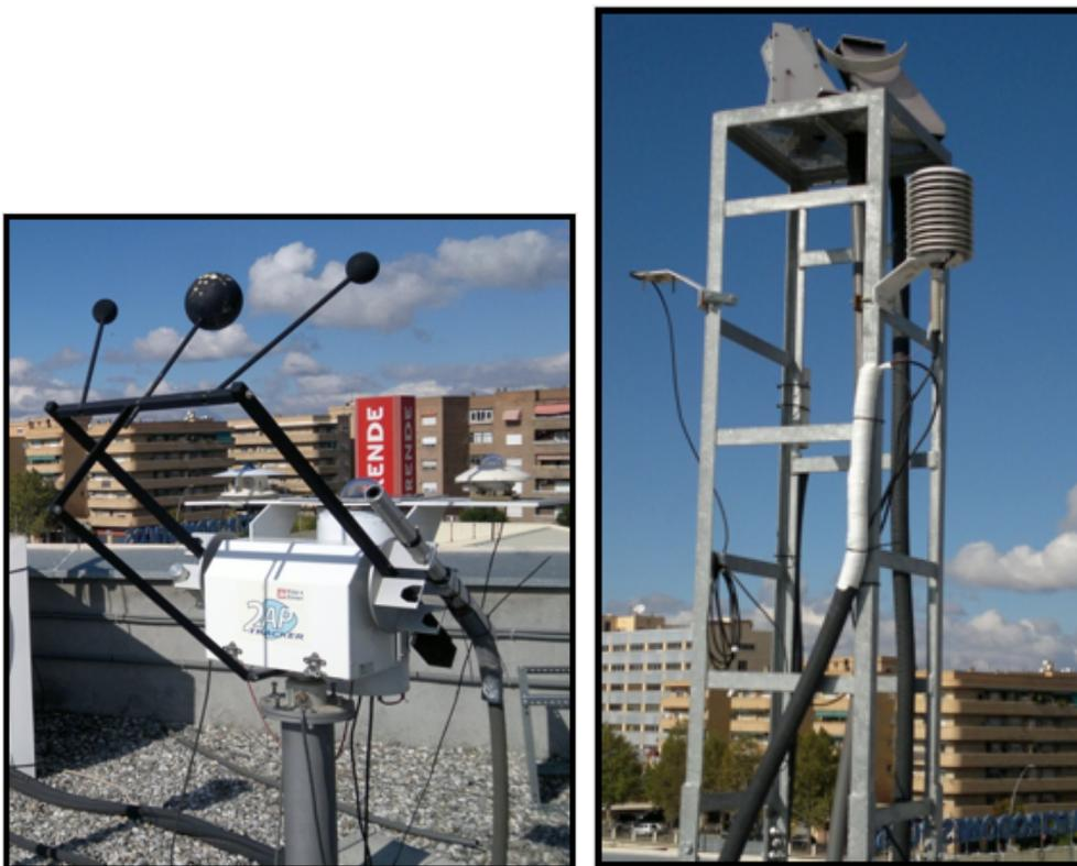
(a) Difusor encargado de medidas de radiación directa (tubo gris a la derecha), montado en el seguidor solar. También se muestran los tres diafragmas ópticos. (b) Difusor encargado de medidas de radiación global y difusa. En la parte superior se puede apreciar la banda de sombra.
