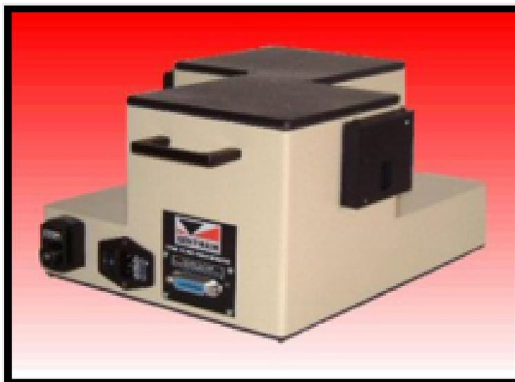
**Figura 2.1:** *Espectrorradiómetro Bentham DMc-150*
