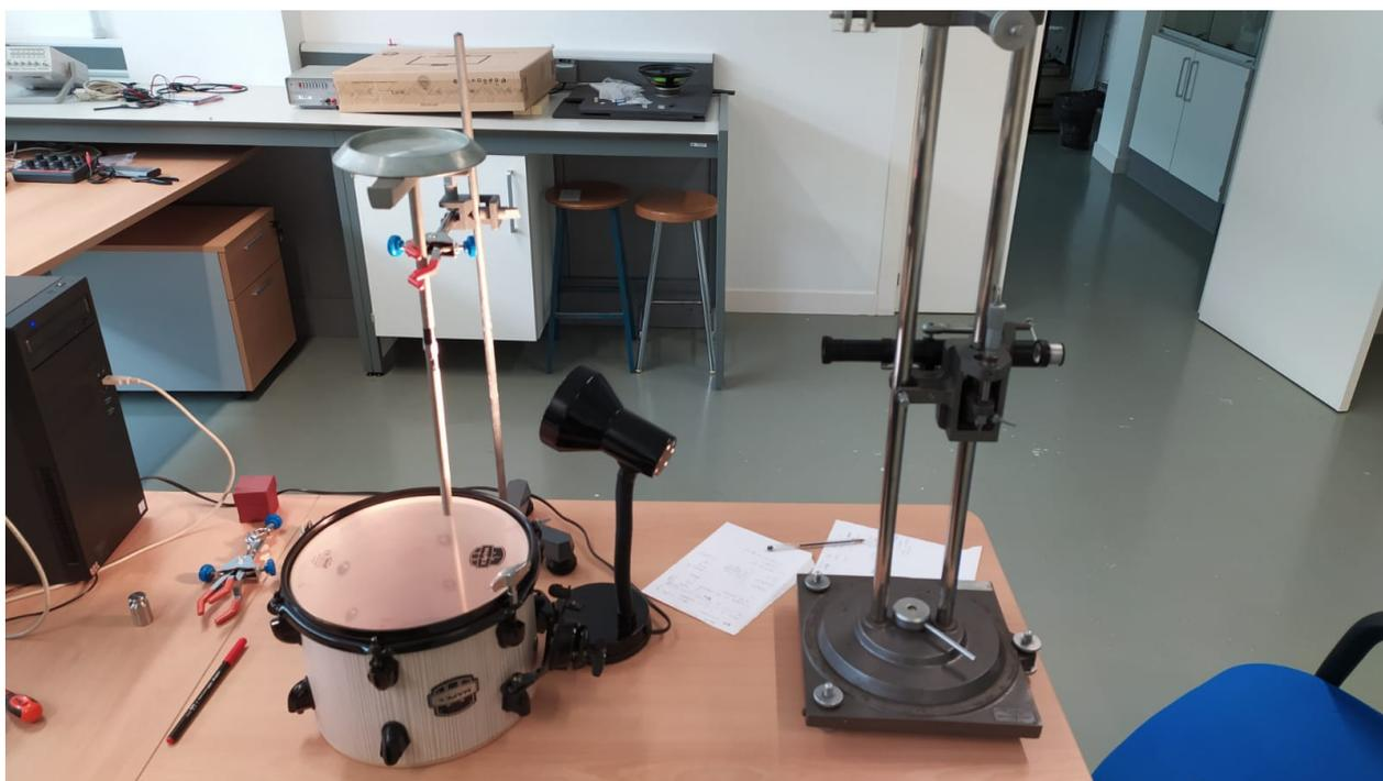
Figura 22: Dispositivo de afinado con catetómetro de la membrana
