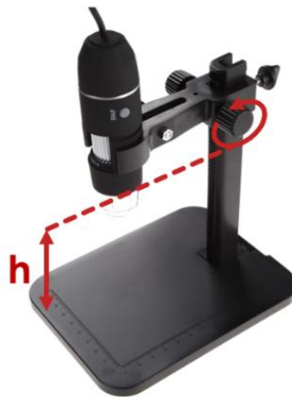
Figura 5.5: Microscopio óptico y soporte de altura variable utilizados.
