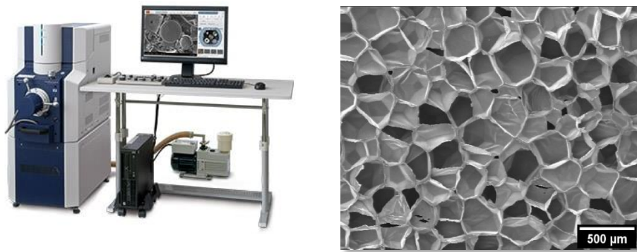
Figura 5.9: Modelo de microscopio FlexSEM 1000, Hitachi, utilizado en el laboratorio. A su lado, un ejemplo de imagen espuma de XPS obtenida por SEM.
