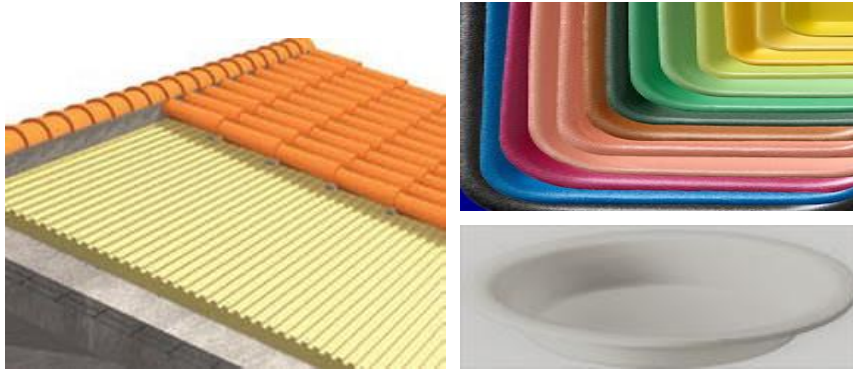
Figura 2.3: Ejemplos de aplicaciones del poliestireno extruido espumado XPS: Cubierta aislante térmica resistente al paso de agua, plato y bandejas de poliestireno extruido espumado.
