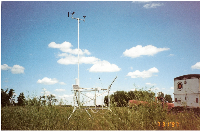
Figura 1.1.1: Estación meteorológica automática en Sheyenne, Dakota del Norte. Imagen extraída de https://raws.dri.edu/ , una de las bases de datos que utiliza GRIDMET.
