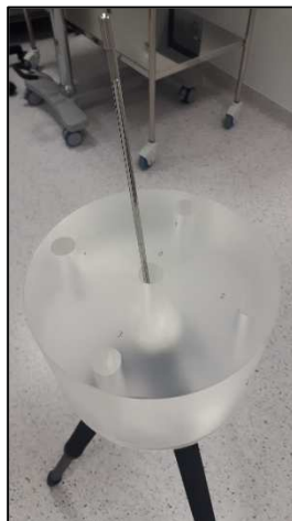
Figura 4-10: Aplicador uterino recto colocado en el compartimento central del fantoma de Krieger
