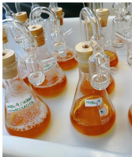
Figura 1: Microvinificaciones en matraces Erlenmeyer de 100 ml, sellados con válvula Müller.
