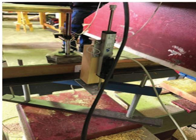
Figura 23. Imagen de detalle de implementación de extensómetros (Fuente: CESEFOR)
