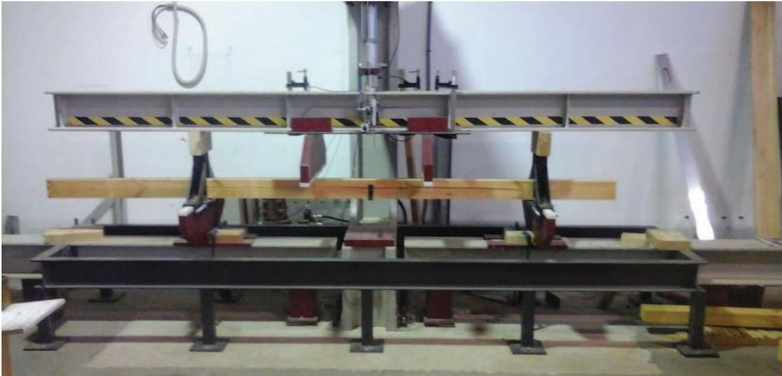
Figura 19. Imagen de la máquina universal de ensayos a flexión
