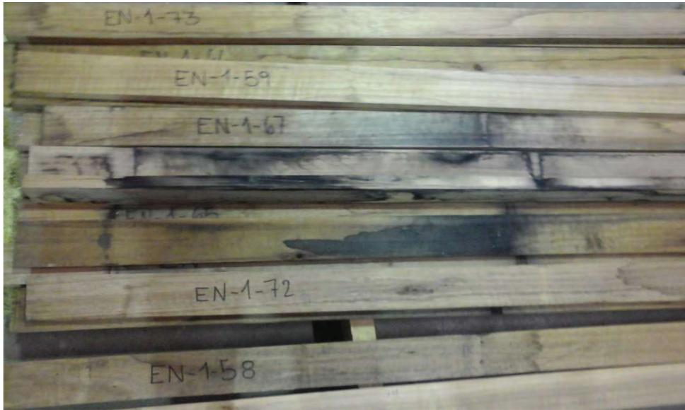
Figura 20. Imagen de las probetas de *Eucalyptus nitens* termotratadas (Fuente: Elaboración propia)
