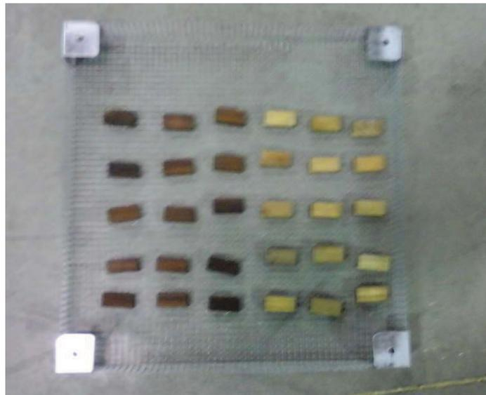
Figura 29. Imagen de las probetas para que alcancen su estado de equilibrio higroscópico (Fuente: Elaboración propia)
