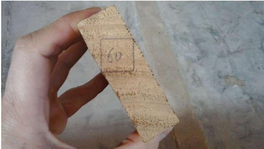
Figura 27. Imagen de preparación de una probeta a partir de la rodaja
