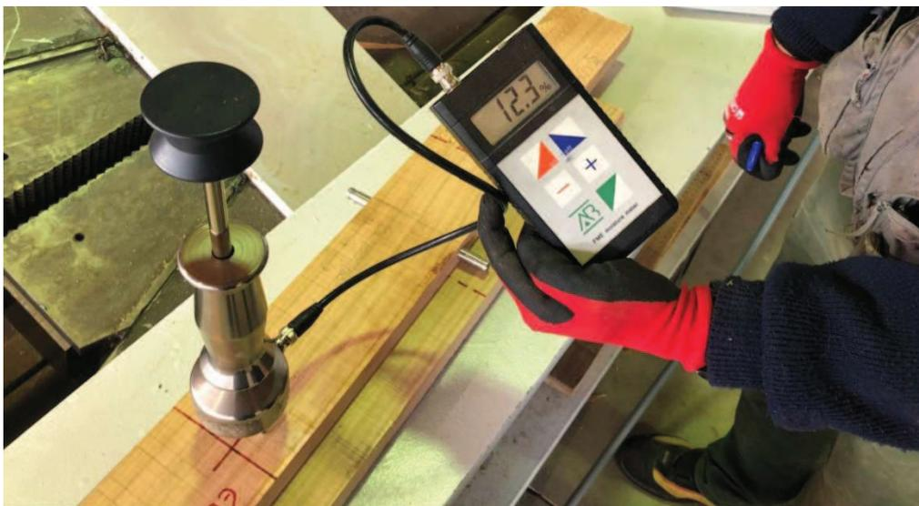
Figura 21. Imagen de la medición del contenido de humedad con xilohigrómetro (Fuente: CESEFOR)
