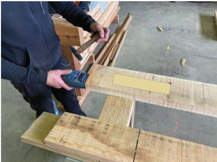
Figura 18. Imagen de medición de una probeta con MTG
