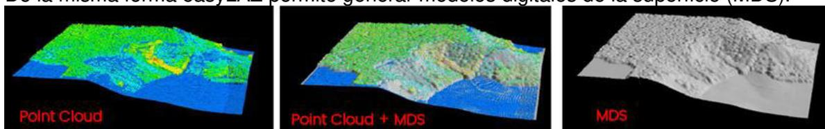
**Ilustración 30. Superposición del MDS con la nube de puntos**
