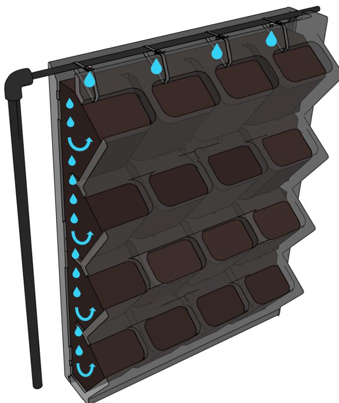
Figura 1. Sistema modular vacío en forma de macetas (Fuente: [www.projar.es](http://www.projar.es)).
