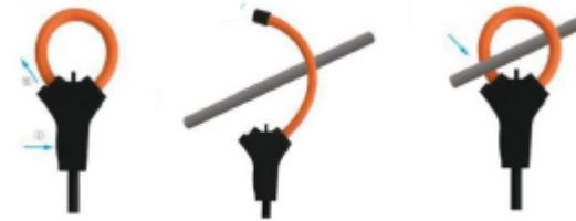
Figura 2: Colocación de una bobina Rogowski [14]
