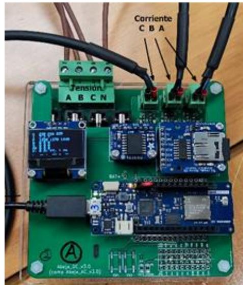
Figura 31: Prototipo del equipo de submetering
