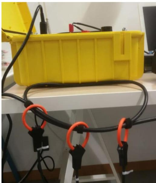
*Figura 35: Arrollamiento del cable para medidas comprendidas entre 30 y 60 A*
