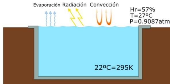
Figura 7 Diagrama ilustrativo del modelo de transmisión de calor de una piscina.
