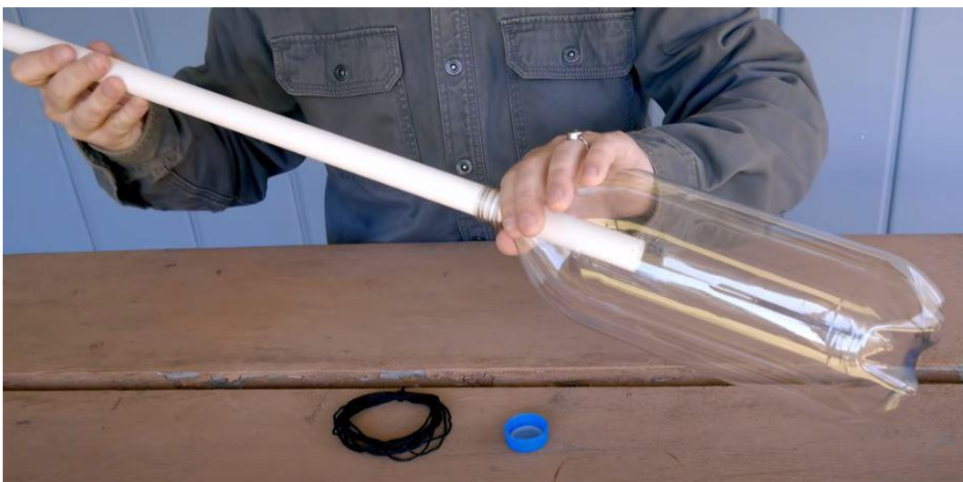
Figura 3.3. Introducción del tubo en la botella
