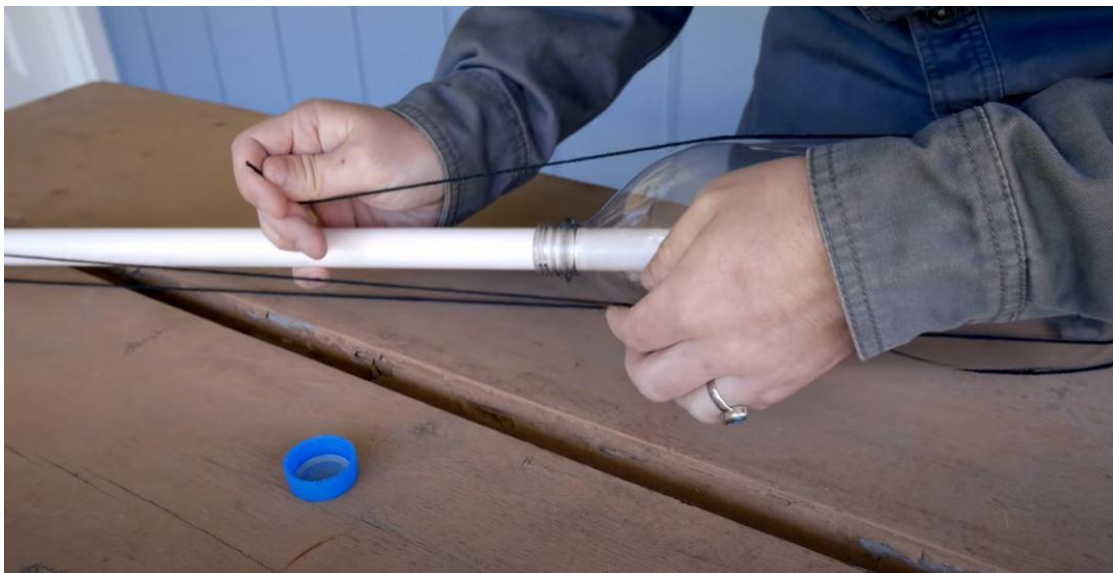
Figura 3.9. Realización del nudo de agarre en línea tensa (1)
