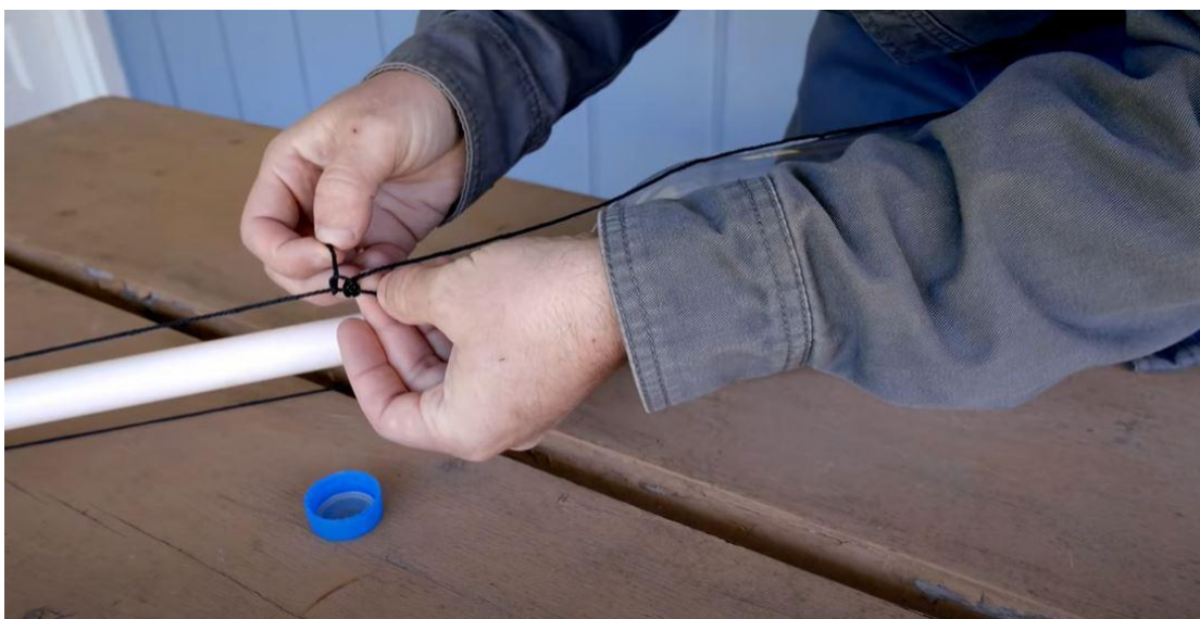
Figura 3.11. Realización del nudo de agarre en línea atensa (2)
