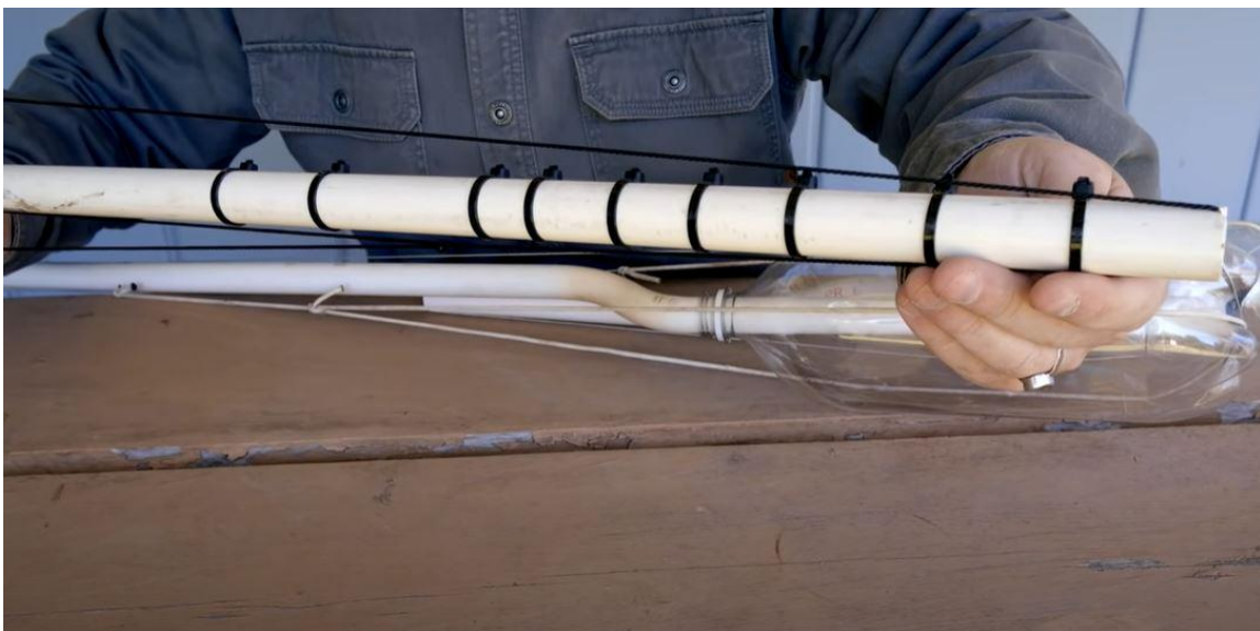
Figura 3.13. Colocación de bridas
