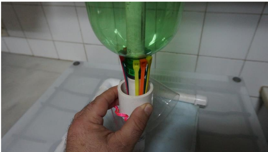
Figura 31. Dispositivo estanqueidad compuesto por una serie de cabezas de bridas unidas por cinta junto con un tubo que sirve como dispositivo de seguridad. Imagen obtenida de Roca Vicent, Gumbau Gil y Sanchis Campreciós (2017).
