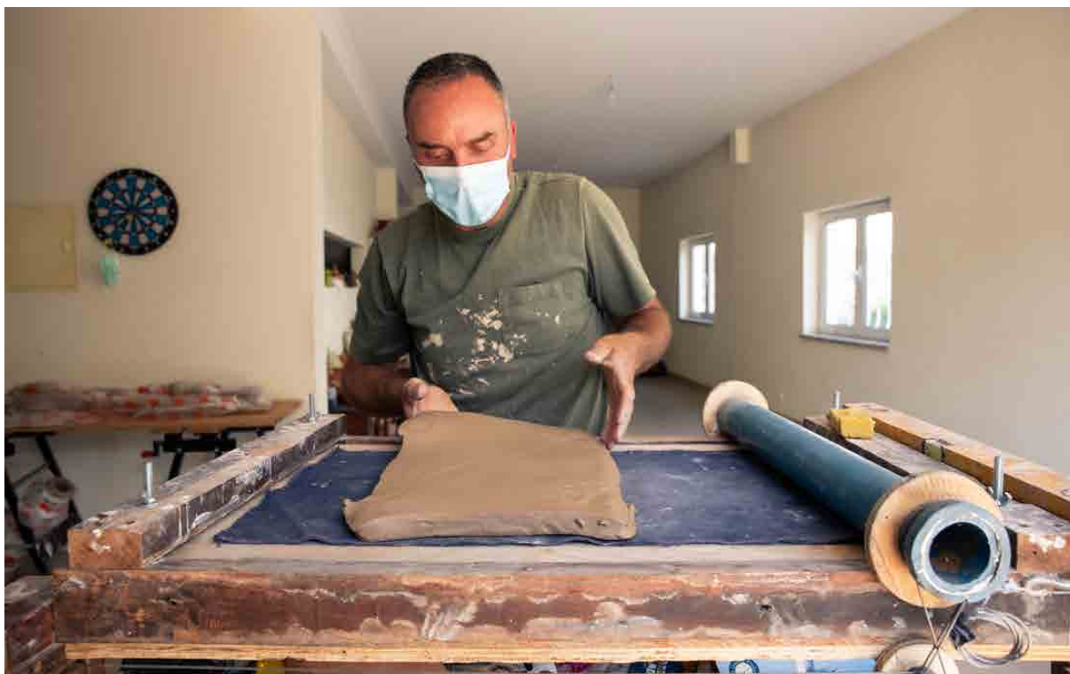
Figura 4. Máquina manual de prensagem das lajetas de barro. Fotografia: M. I. Mendonça (2021).
