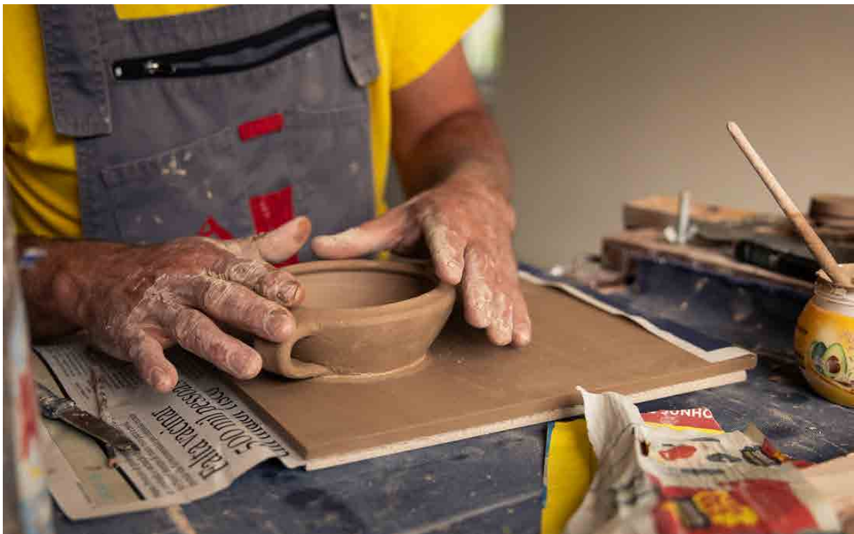
Figura 5. Justaposição das partes de peças modeladas na roda sobre as lajetas. Fotografia: M. I. Mendonça (2021).
