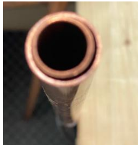
Figura 29. Tubos concéntricos para aumentar el espesor.
