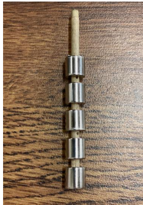
Figura 27. Imanes separados a repulsión.
