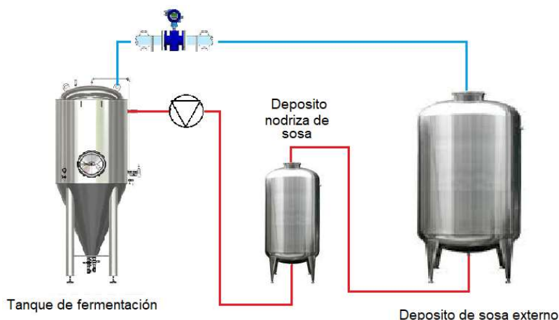
Figura 4. Opciones que se plantearon para realizar la regulación pH de la nueva receta de masa madre. En la figura, la línea azul representa la primera opción de tomar directamente sosa (NaOH) del depósito externo y adicionarlo con un picaje en la zona superior del fermentador, controlado con un caudalímetro. Por otro lado, la línea roja representa la segunda opción de instalar un depósito nodriza, que ira adicionando sosa (NaOH) al fermentador a través de una bomba peristáltica.
