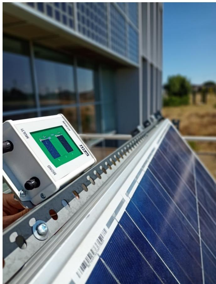
Figura 44: Medición de la irradiancia. Fuente: Elaboración propia.
