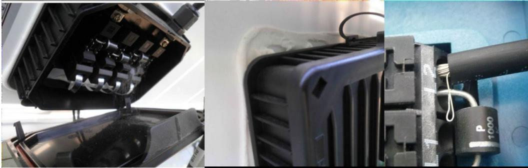
Figura 22: Fallos en la caja de conexiones. Fuente: IEA-PVPS.
