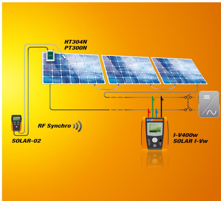
Figura 42: Conexión del trazador de curvas IV. Fuente: [www.ht-instruments.com](http://www.ht-instruments.com)
