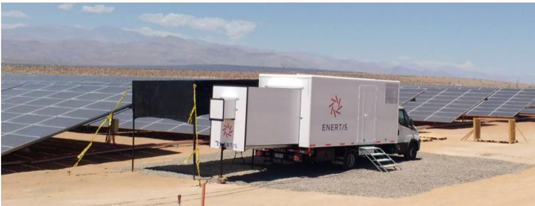
Figura 19: Centro móvil para la caracterización de módulos fotovoltaicos de ENERTIS. Fuente: [www.enertis.com](http://www.enertis.com)
