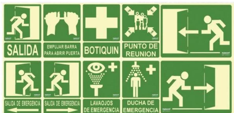
Figura 10.1. Señalización de los elementos de evacuación
