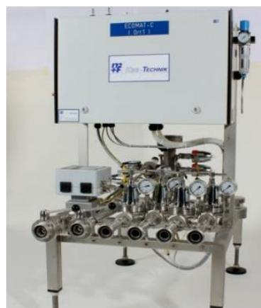
Figura 5.30. Máquina envasadora barriles
