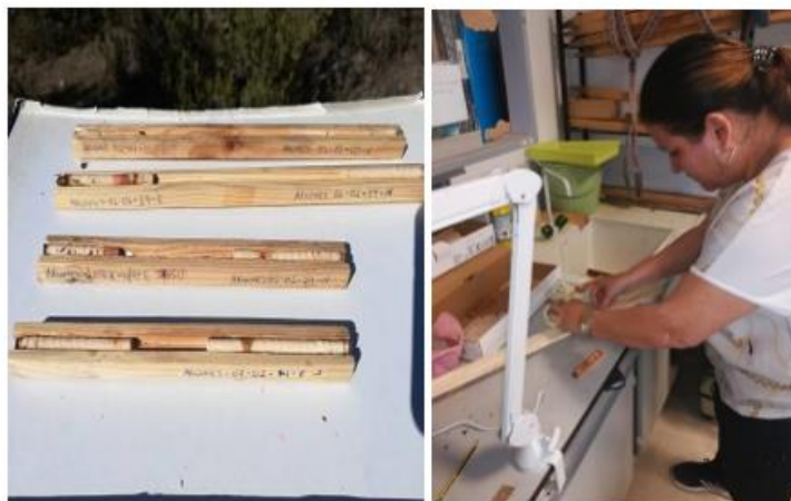
Figura 7: Montaje y secado de los testigos (muestras) en las tablillas de madera. Fuente: propia.
