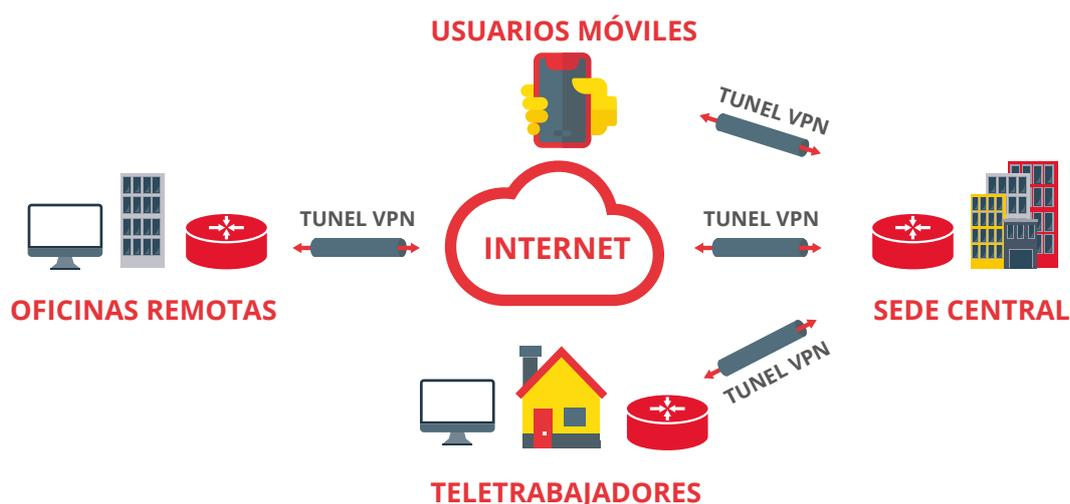
**Ilustración 1 Estructura de una VPN para una empresa**
