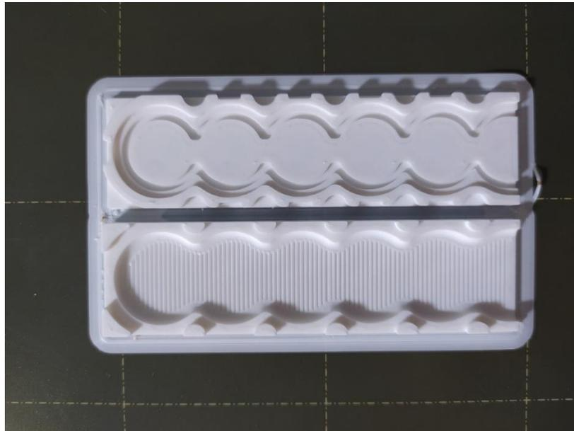
**Ilustración 25: impresión en ABS del molde inferior.**
