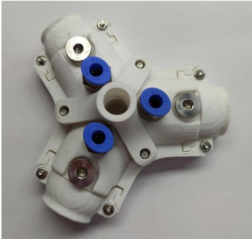
**Ilustración 43: modelo final de la garra impreso. Vista superior.**
