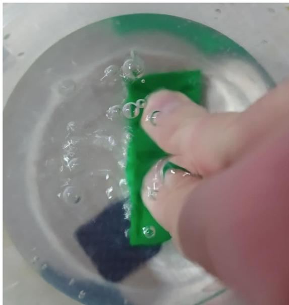
**Ilustración 11: prueba de estanqueidad.**
