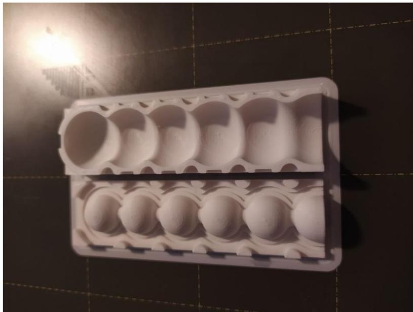
**Ilustración 26: impresión en ABS del molde superior.**
