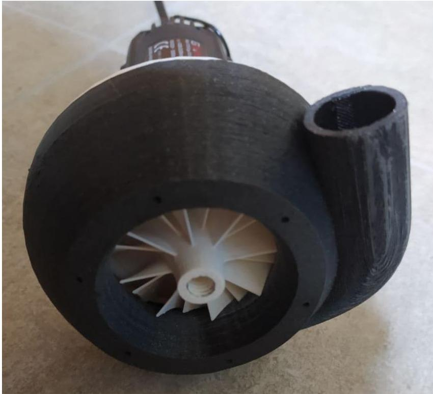
**Ilustración 66: vista frontal de la turbina montada.**
