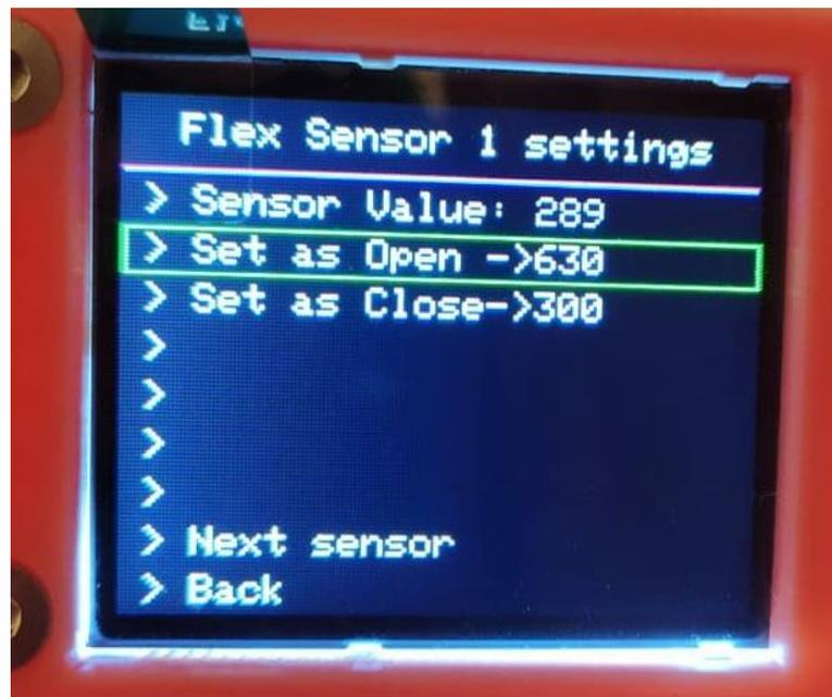
Ilustración 73: pantalla ajuste sensores.
