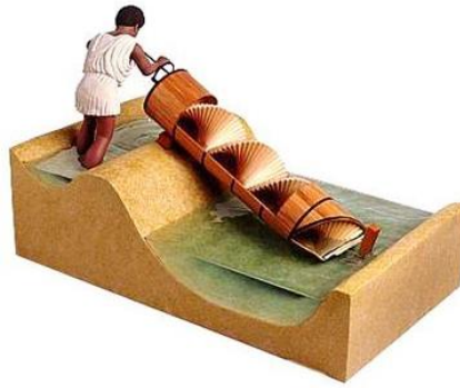
Ilustración 28. Tornillo sin fin de Arquímedes. Recuperado de [Casanova F., (2009)]
