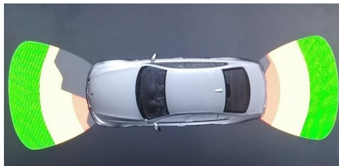
Ilustración 62. Alcance sensores de proximidad modelo BMW 320d, año 2012 [Elaboración propia]
