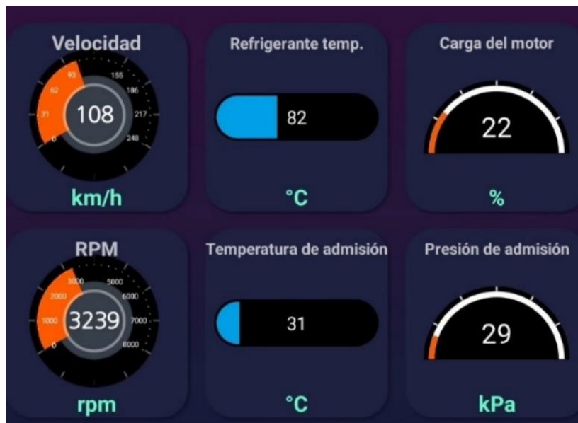
Ilustración 65. Interface con lecturas a tiempo real durante la conducción de un modelo Renault Laguna II. [Elaboración propia]
