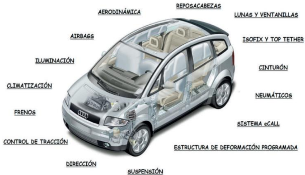
Ilustración 40. Sistemas mecánicos que han sido complementados (o sustituidos) por componentes electrónicos. Recuperado de [Gómez, Noroña, M., M. (2019)]
