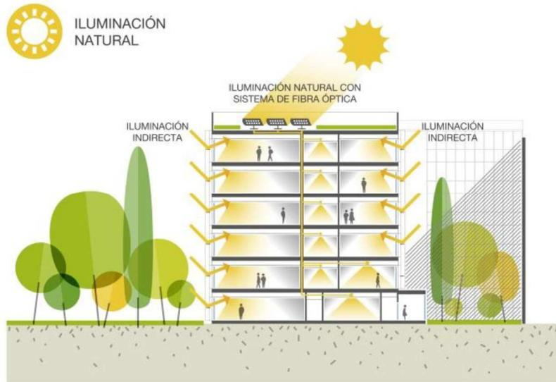
Ilustración 26. Esquema funcionamiento iluminación con fibra óptica. Fuente: (Fundación CONAMA, 2016)
