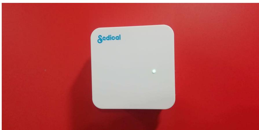
Ilustración 39. Sensor de CO<sub>2</sub> instalado en las aulas del IndUVa. Fuente: Elaboración propia (Noviembre 2021)
