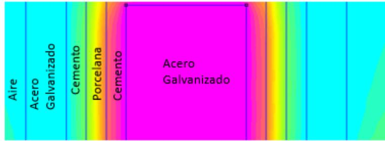
Figura 66: Análisis de las distintas capas del aislador con la geometría simplificada
