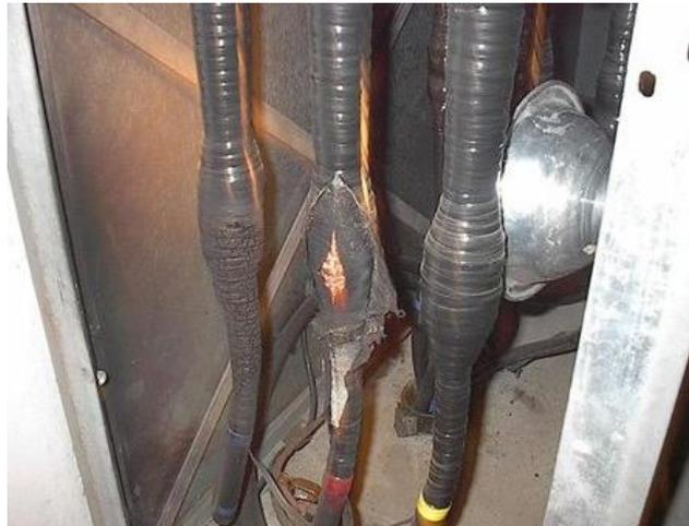
Figura 23: Rotura de aislamiento causado por descargas parciales
