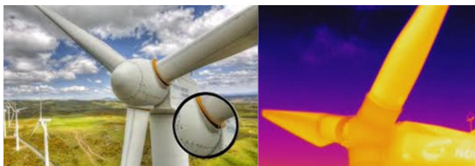
Ilustración 13. Inspección termográfica de un aerogenerador eólico [38].
