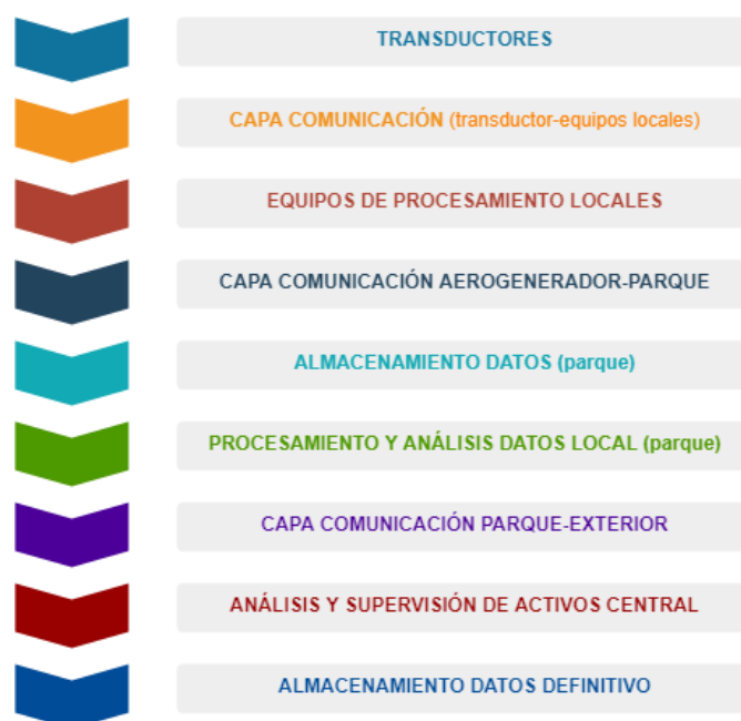
Ilustración 19. Capas de la estructura del sistema de control y monitorización ideal de un aerogenerador.
