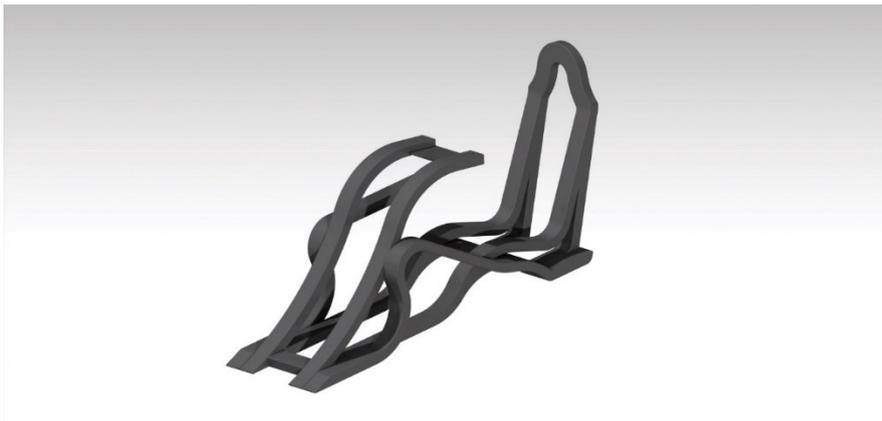
En esta estructura se ancla el asiento, los embellecedores, la pedalera y el volante, además se ha incluido en la estructura un soporte para palancas de cambio.
