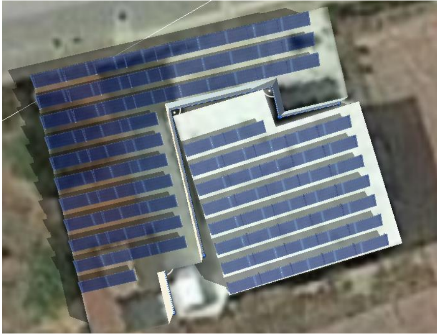
Figura 3.20- Distribución en planta de placas fotovoltaicas completa
