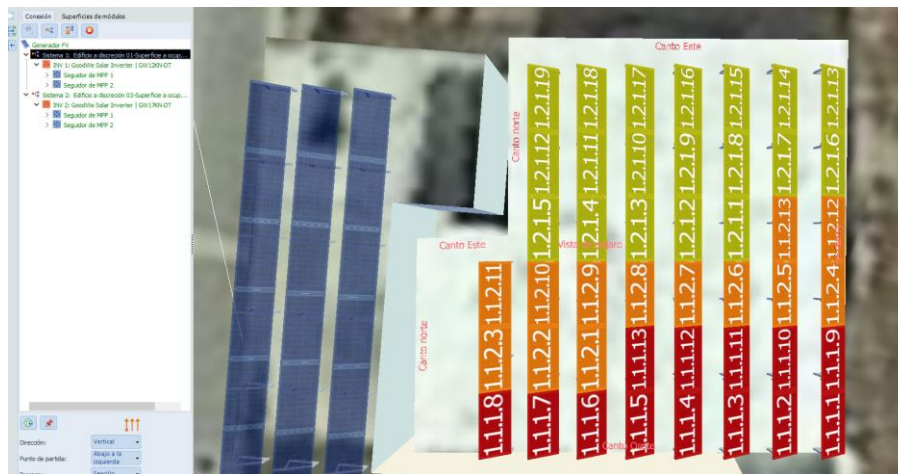
Figura 3.27- Inter-conexionado de las placas fotovoltaicas de cubierta
