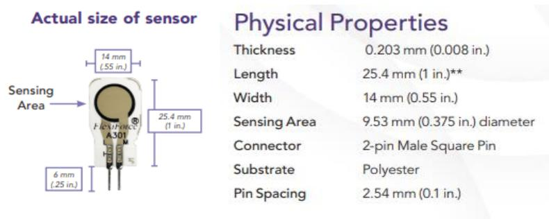
Figura 8: Dimensiones y propiedades del sensor A301.
