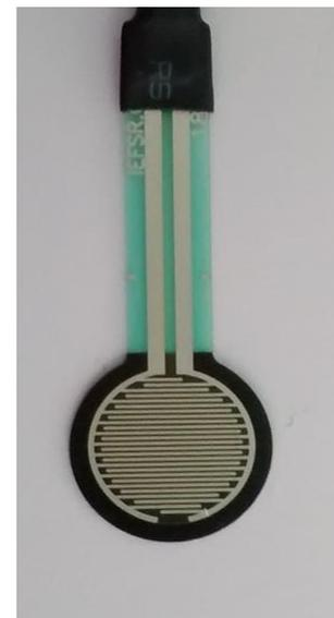
Medida de la fuerza mediante sensores de tipo film
