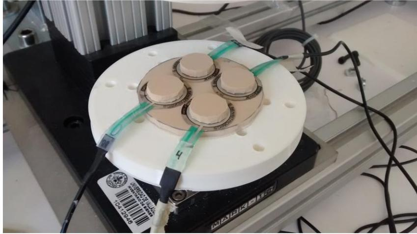
Figura 117: Imagen de los sensores en el ensayo plano con puck.
