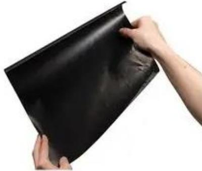
Figura 28: Film piezorresistivo de Velostat.
