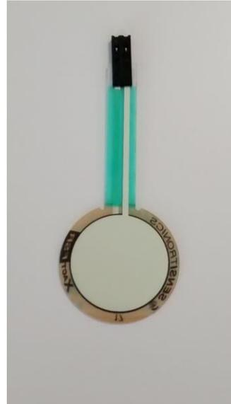
Figura 33: Sensor Truemode de Sensitronics.
