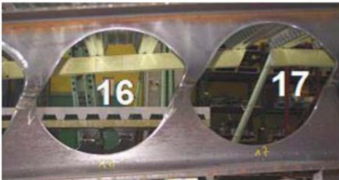
Figura 76 - Fallo por cizallamiento
