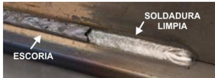
Figura 29 - Escoria cordón soldadura
