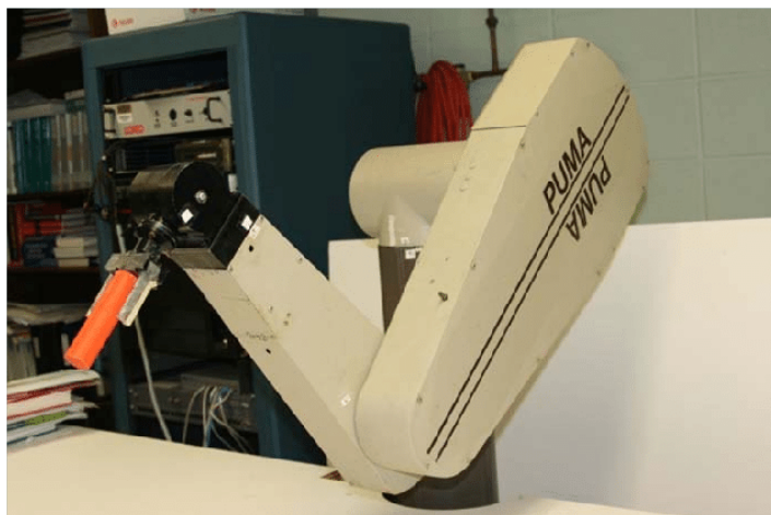
Figura 3. Robot industrial “PUMA 560” que fue empleado para introducir una aguja en un cerebro humano mediante guía TAC (Hsien, 2013)
