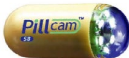
Figura 7. Ejemplo de cápsula endoscópica comercial con cámara Pillcam (Swain, 2003)
