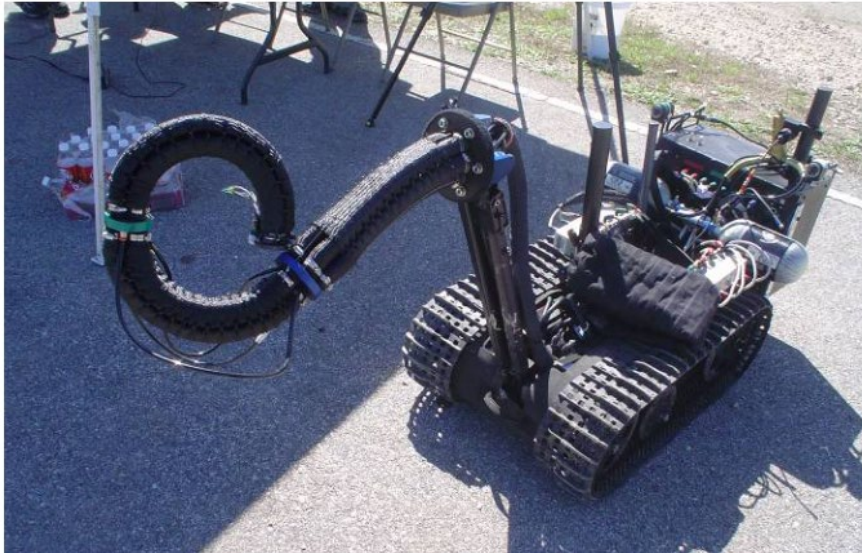
Figura 8. Brazo robótico OctArm , montado sobre una plataforma móvil TALON de Foster-Miller (McMahan, 2006)
