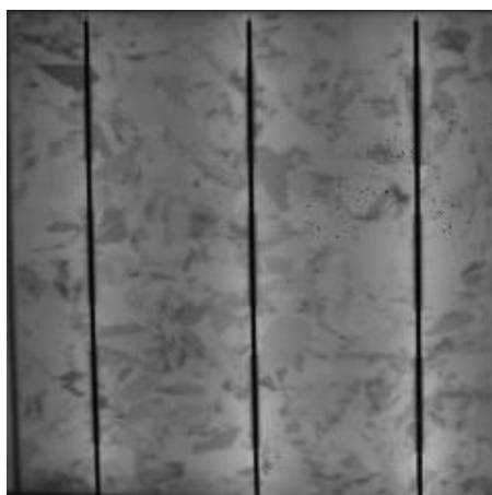
Figura 3.45: Fronteras de grano en Si policristalino (PV-Elaboración Propia, 2020)
