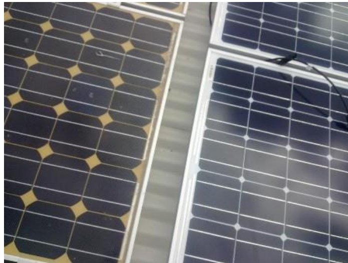
Figura 3.11: Fotografías de un módulo afectado por el amarilleamiento. (Scenicroutepaper, 2020)
