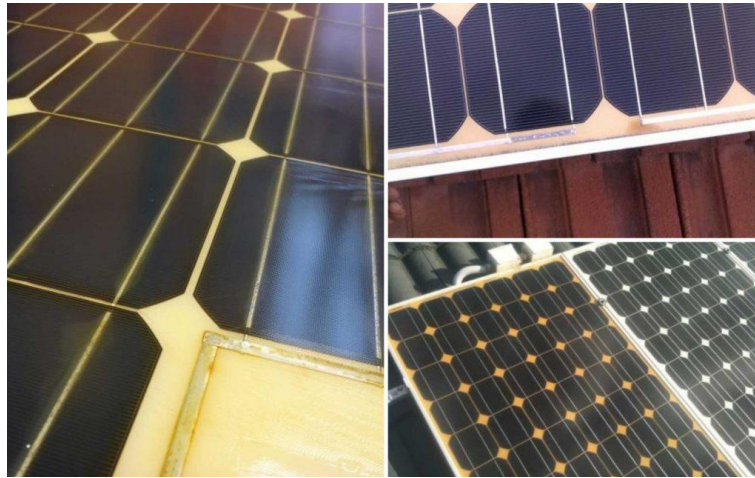
Figura 3.6: Fotografías de paneles dañados por la corrosión debido a fallo localizado en el encapsulante. (Revier.Solar, 2018)
