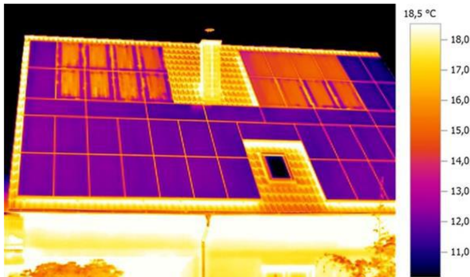
Figura 3.25: Fotografías tomadas de una planta con módulos afectados por el PID. (Photovoltaic, 2018)
