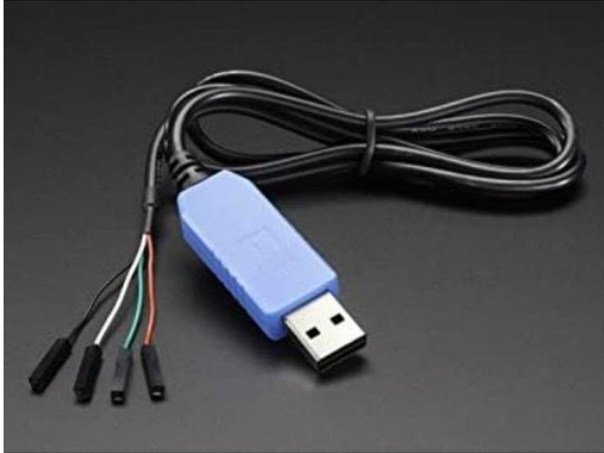
*Figura 4.4 - Adaptador USB-ttl*
