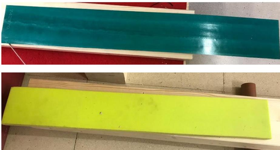
*Figura 3.3. Imagen superior Sylodamp más rígido, imagen inferior Sylodamp menos rígido.*
