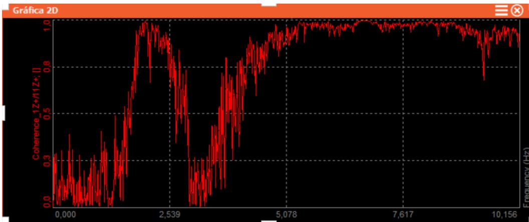
Figura 3.12. Función de coherencia.
