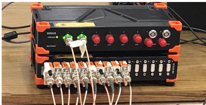
*Figura 3.6. Tarjeta de adquisición de datos SIRIUS HD-STG.*
