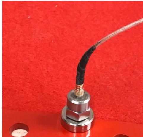
*Figura 3.4. Acelerómetro IEPE-ICP METRA MMF KS76C.10/.100.*
