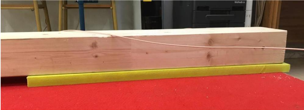
*Figura 3.18. Colocación del Sylodamp entre la viga y la plataforma, configuración experimental ensayo 4.*
