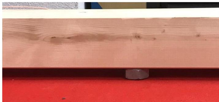
Figura 3.17. Viga elevada con tuercas, configuración experimental ensayo 3.
