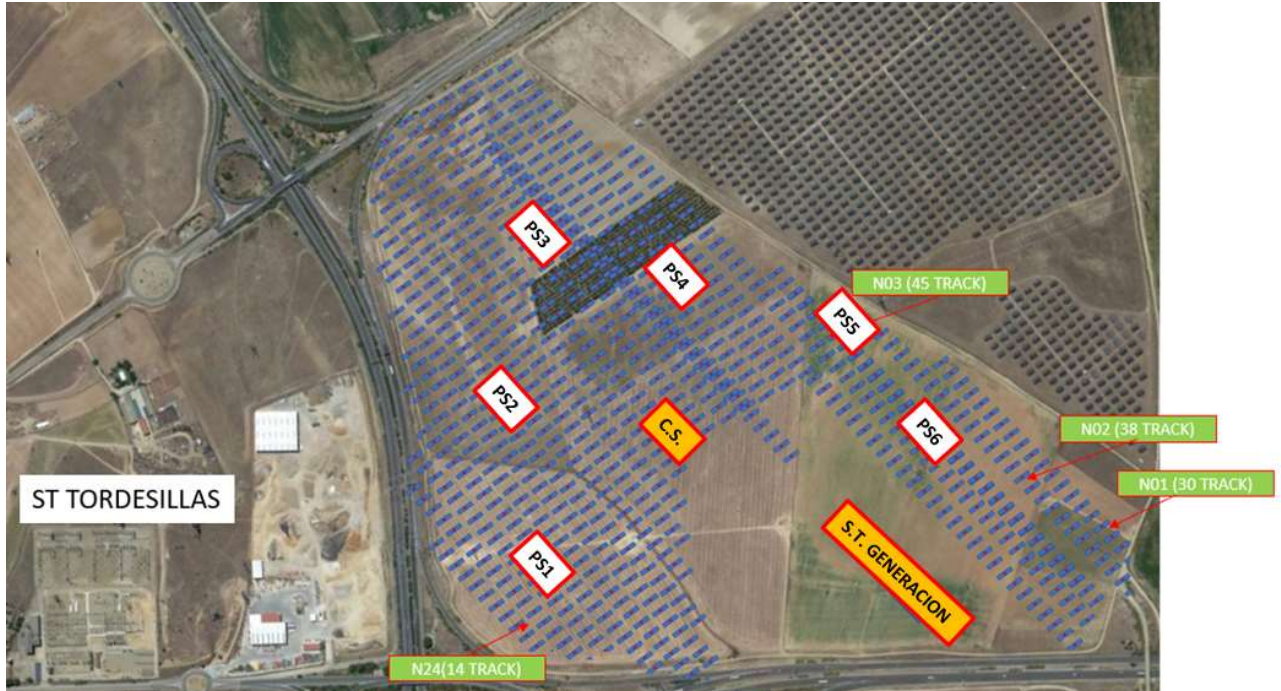
Ilustración 4 Geometría de filas de seguidores de la planta FV y detalle de la ST "GENERACIÓN"
